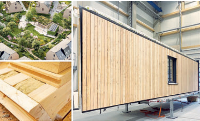
Berlin'deki yeni Kokoni One projesinin ahşap çerçevesi binalarının inşasında, üretici Swiss Krono'nun yönlendirilmiş yonga levha (OSB) panelleri kullanıldı. Telif Hakki: ZRS Architekten Ingenieure
