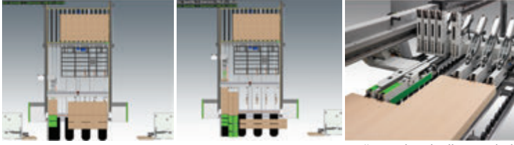
Bağımsız hareketli tutucularla değişik ölçülerin eş zamanda kesilme imkanı
