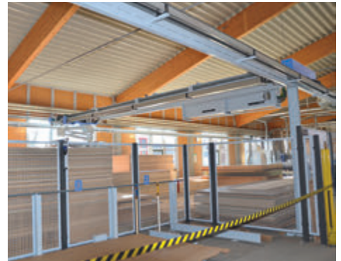
Otomatik panel depolama sistemi TLF 211, standart büyüklük ölçüsü olan 5.600 x 2.200 mm'ye kadar bütün malzeme cinslerini rahatlıkla taşıyabiliyor.
